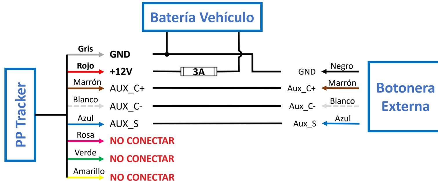
Imagen 7. ESQUEMA DE CONEXIÓN ELÉCTRICA PPTRACKER
